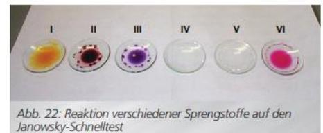
Abb. 22: Reaktion verschiedener Sprengstoffe auf den Janowsky-Schnelltest
